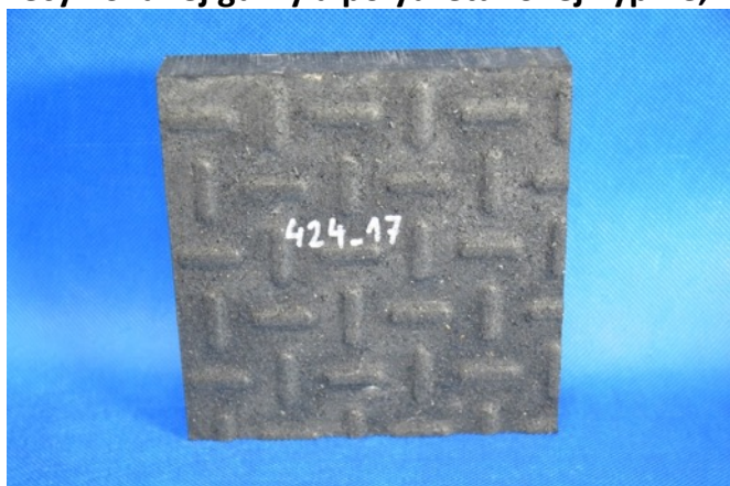
2608_424_17 – Heavy duty 30 kompozitný gumový podlahový dielec pozostávajúci z recyklovanej gumy a polyuretánovej výplne, veľkosť vzorky 150mm x 151mm x 30mm
